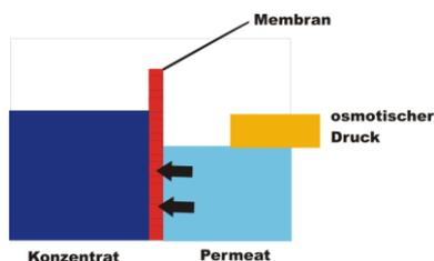
Kehrt man diesen Ablauf um, indem man auf die höher konzentrierte Lösung Druck ausübt, so fließt nach Überwindung des osmotischen Drucks reines Wasser in der umgekehrten Richtung durch die Membran. Die gelösten Salze bleiben zurück. Diesen Vorgang nennt man Umkehrosmose.
